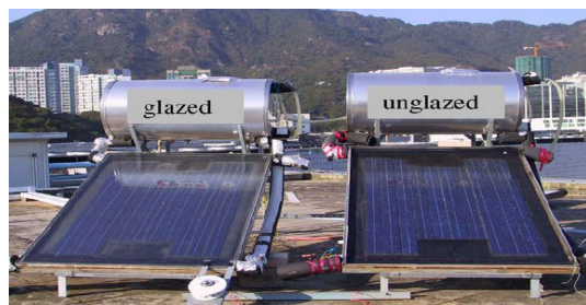
그림 5. PV/T collectors with and without glass cover 34)
